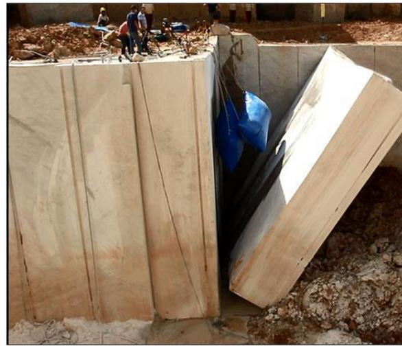
**Figura 12:** Modelo de Travesseiro Pneumático, utilizado na separação e derrubada das bancadas. Fonte: Google Imagens.
