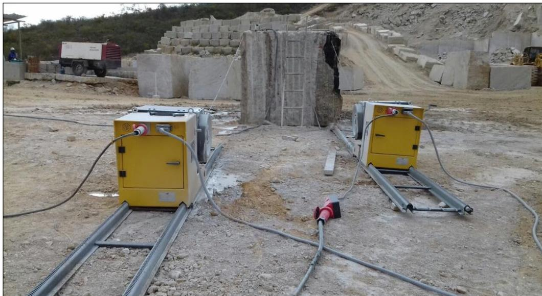
c) Máquina à Fio Diamantado em funcionamento.
