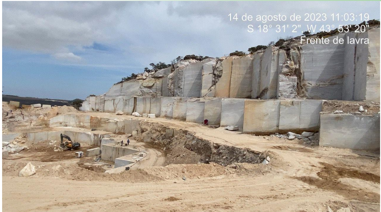
Figura 62: Frente da atual lavra onde se observa a extração em grandes blocos devido ao cáter maciço do quartzito.
