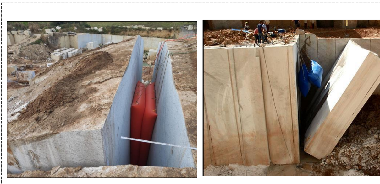
Figura 9: Modelo de Travesseiro Pneumático, utilizado na separação e derrubada das bancadas. Fonte: Google Imagens.
